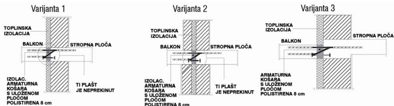
Slika 2. Varijante ugradnje izolacijske armaturne košare
