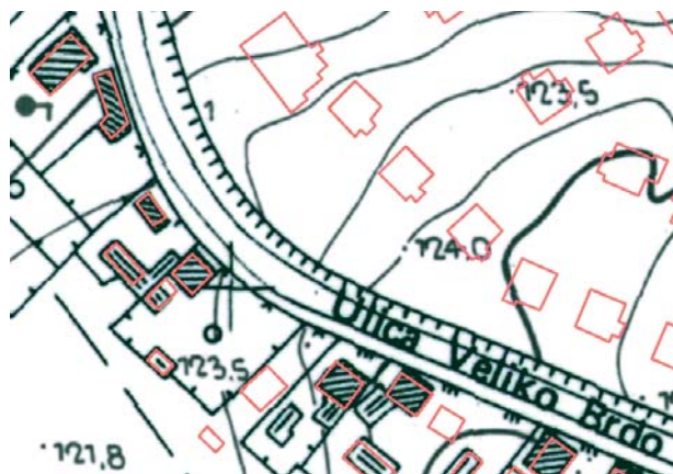
Slika 12. Nadopuna HOK-a sa stvarnim stanjem na terenu (preklop s digitalnim katastarskim planom)
