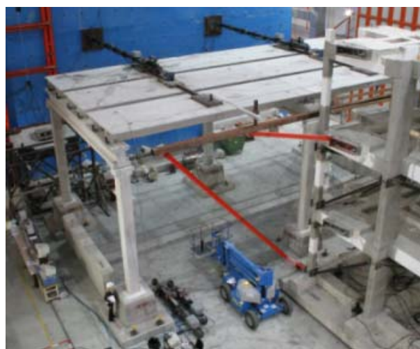
Slika 1. Model za vrijeme pseudodinamičkog ispitivanja u laboratoriju ELSA
