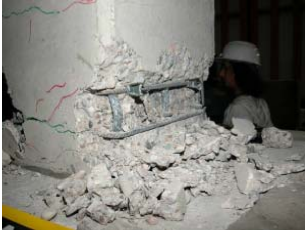
Slika 10. Tipično rušenje stupa na savijanje
