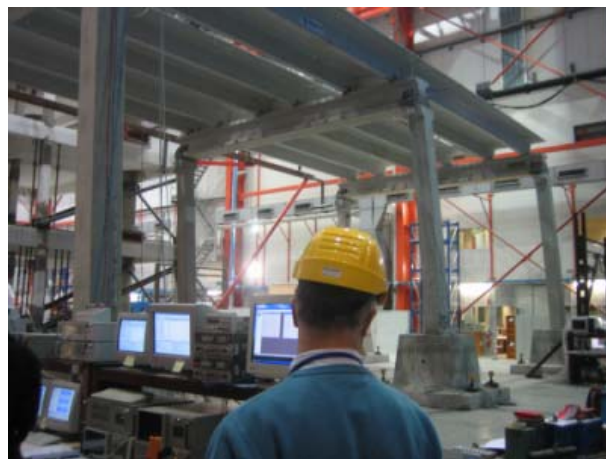
Slika 8. Deformirana konstrukcija uzorka 2-2 pri katnom pomaku od 8 %
