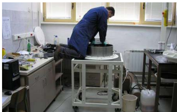
Slika 19. Zbijanje uzorka vlastitom težinom tijela
