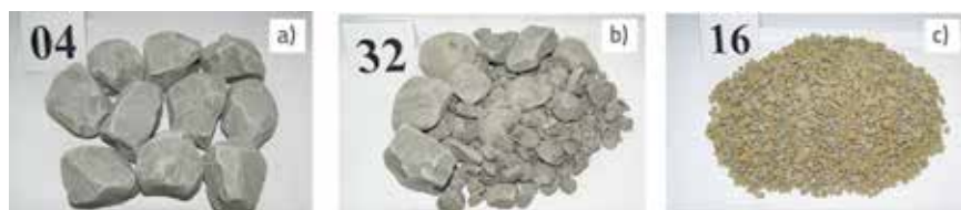
Slika 4. Primjer ostatka nakon 4. ciklusa vrtnje za tri tipa lapora: a) Tip I; b) Tip II; c) Tip III [28]
