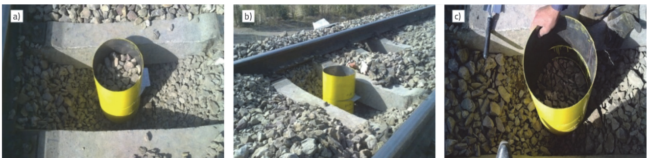
Slika 5. Uzimanje uzoraka tucanika iz različitih slojeva: a) uzorak iz gornjeg sloja; b) uzorak iz srednjeg sloja; c) uzorak iz donjeg sloja
