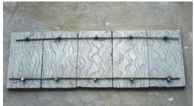
Slika 2. Pripremanje cementnih ploča za izradu kompozita
