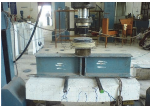
Slika 4. Priprema eksperimenta: ferocementna ab kompozitna ploča
