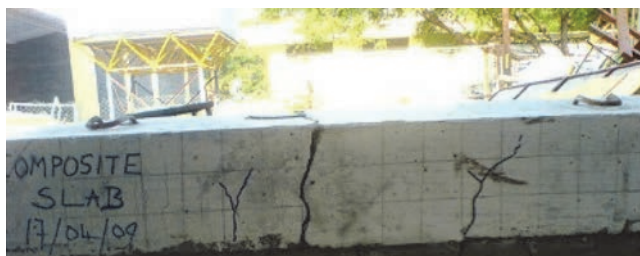
Slika 9. Kompozitna ploča nakon popuštanja
