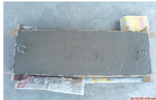
Slika 3. Kompozitna ploča nakon ugradnje betona na ferocemente ploče
