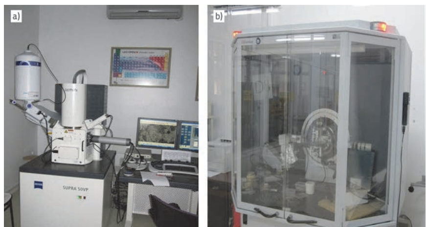
Slika 1. a) SEM-EDS uređaj; b) XRD uređaj
