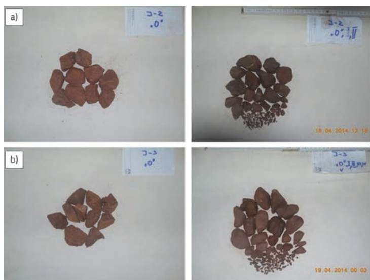
Slika 9. a) Uzorak s km 28+650 prije pokusa i nakon drugog ciklusa, b) Uzorak s km 30+200 prije pokusa i nakon petog ciklusa, c) Granulometrijske krivulje nakon drugog i petog ciklusa
