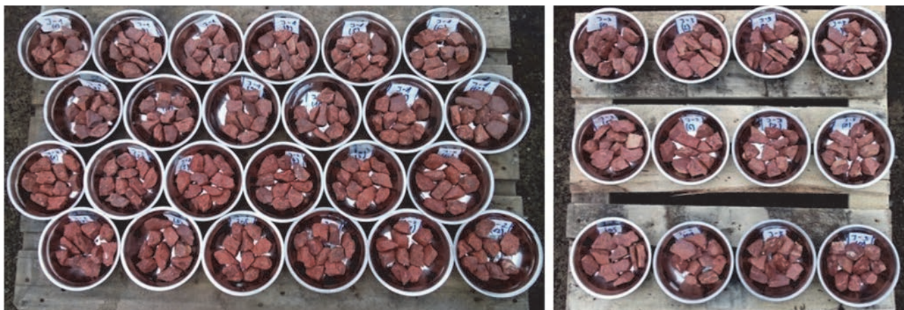
Slika 8. Uzorci izloženi prirodnim klimatskim uvjetima
