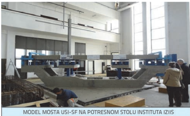
Slika 19. Prototipski model mosta USI-SF za ispitivanje seizmičkog ponašanja postavljen na IZIIS-ovom potresnom stolu, sa dva originalna uređaja SF-ED-4C-L1R-T1 i četiri uređaja DRSRB
