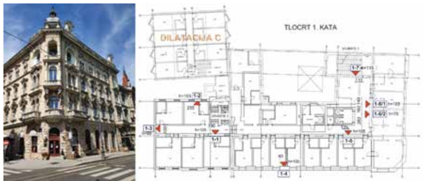
Slika 7. Hotel Palace u Zagrebu (lijevo), tlocrt 1. kata s označenim mjestima ispitivanja posmične čvrstoće zida (desno)
