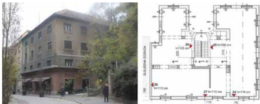
Slika 3. Stambeno-poslovna građevina, Ulica Ivana Dežmana 9 u Zagrebu (lijevo), tlocrt 3. kata s označenim mjestima ispitivanja posmične čvrstoće ziđa (desno)
