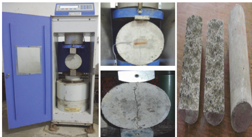
Slika 7. Prikaz ispitivanja čvrstoće pri cijepanju
