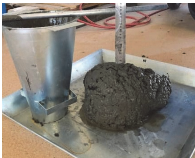
Slika 4. Ispitivanje konzistencije betona metodom slijeganja
