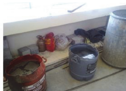
Slika 3. Betonske kocke uronjene u otopinu klorovodične kiseline (HCl)
