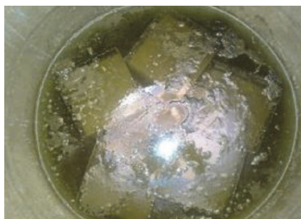
Slika 3. Betonske kocke uronjene u otopinu klorovodične kiseline (HCl)
