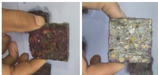
Slika 11. Test karbonizacije nakon 20 dana ekstrakcije iz NaCl
