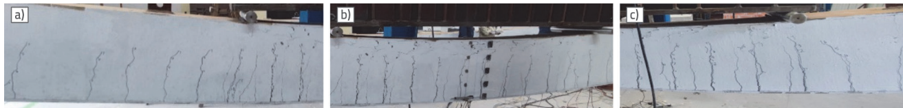
Slika 11. Konačno stanje sloma uzorka PECB2: a) područje sjeverne strane; b) područje srednjeg raspona; c) područje južne strane
