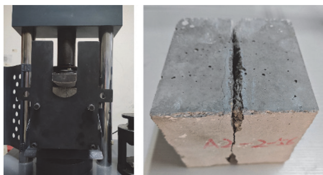
Slika 7. Karakteristični oblik loma DSBFC-a pri ispitivanju vlačne čvrstoće cijepanjem
