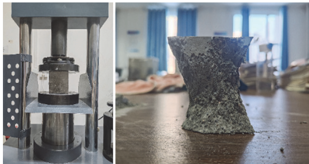
Slika 5. Karakteristični oblik loma DSBFC-a pri tlačnome opterećenju
