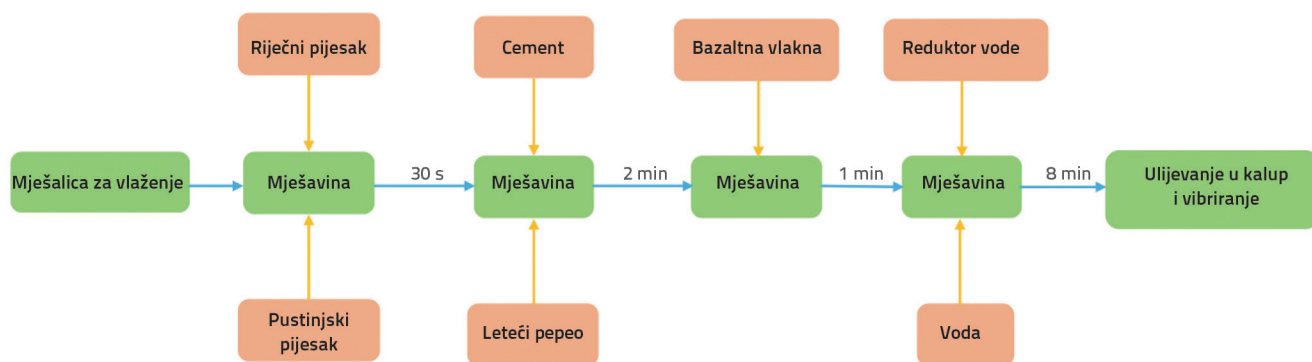
Slika 2. Dijagram postupka pripreme uzorka
