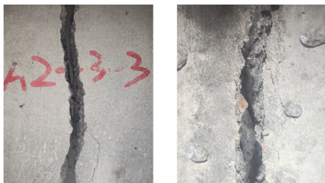
Slika 8. Površina loma DSBFC-a nakon ispitivanja vlačne čvrstoće cijepanjem
