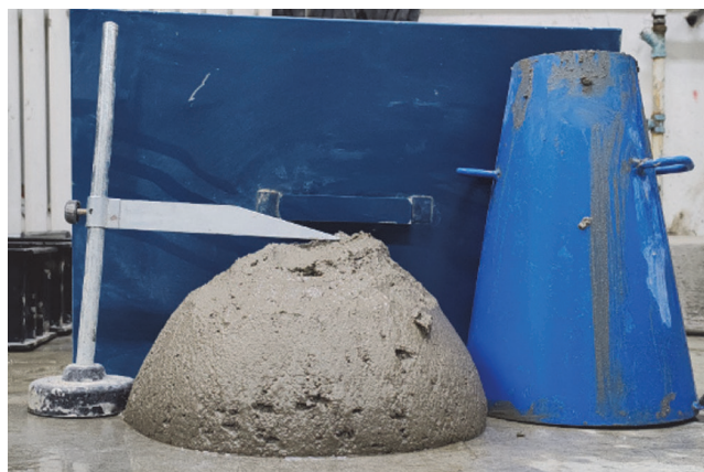
Slika 4. Slijeganje betona s pustinjaškim pijeskom i bazaltnim vlaknima (DSBFC)
