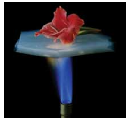
Cvijet zaštićen od plamena aerogelom debljine 6 mm
