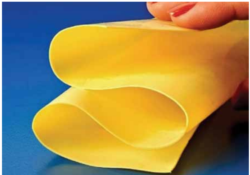
Fleksibilni komad novog polimer aerogela
