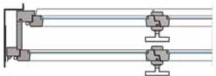
Slika 10. Horizontalni presjek dvostrukog dvokrillnog prozora
