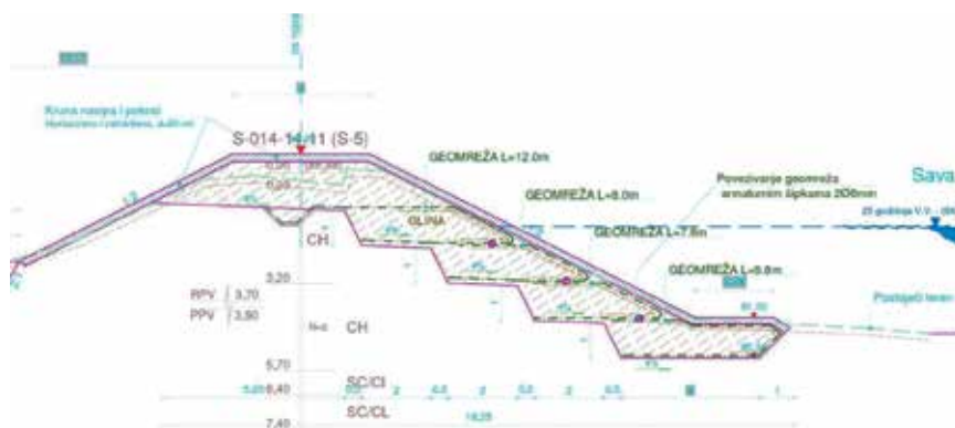
Prikaz alternativnog rješenja sanacije nasipa uzvodno od odrona u Račinovcima
